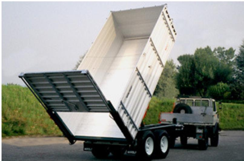
Hydraulisch öffnende Heckwand mit integriertem Schieber (500 x 450 mm). Vom Zugfahrzeug aus bedienbar, es ist keine manuelle Entriegelung notwendig
