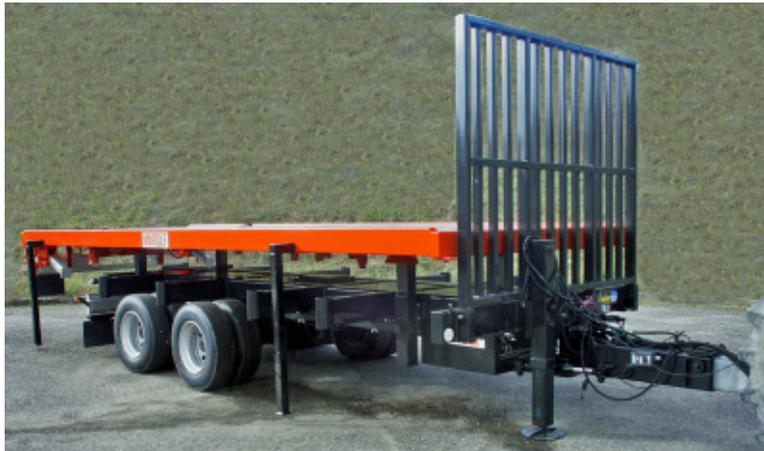
**Tandemfahrgestell für Langholztransport mit Wechselsystem für Maschinen- und Ballentransport, Gesteinsmulde und Viehaufbau. Zugdeichsel hydraulisch schwenk- und ausziehbar. Hinterachse als Nachlaufachse mit manueller, funkgesteuerter Zwangslenkung.**
