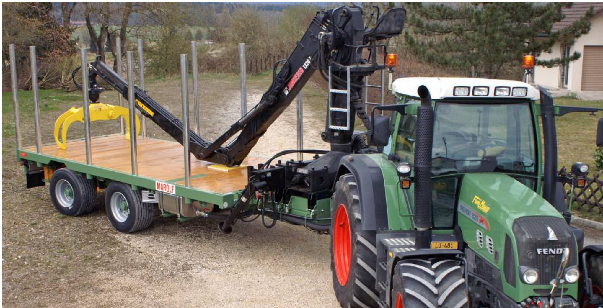
Zwangsgelenkte Nachlaufachse essieu suiveur directionel forcé
