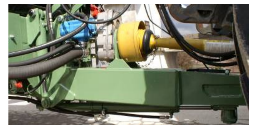
Hydraulische Deichselfederung Flèche ressort hydraulique
