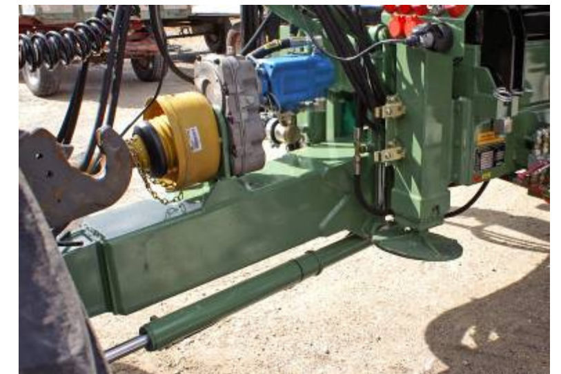
Zwangsgelenkte Nachlaufachse essieu suiveur directionel forcé
