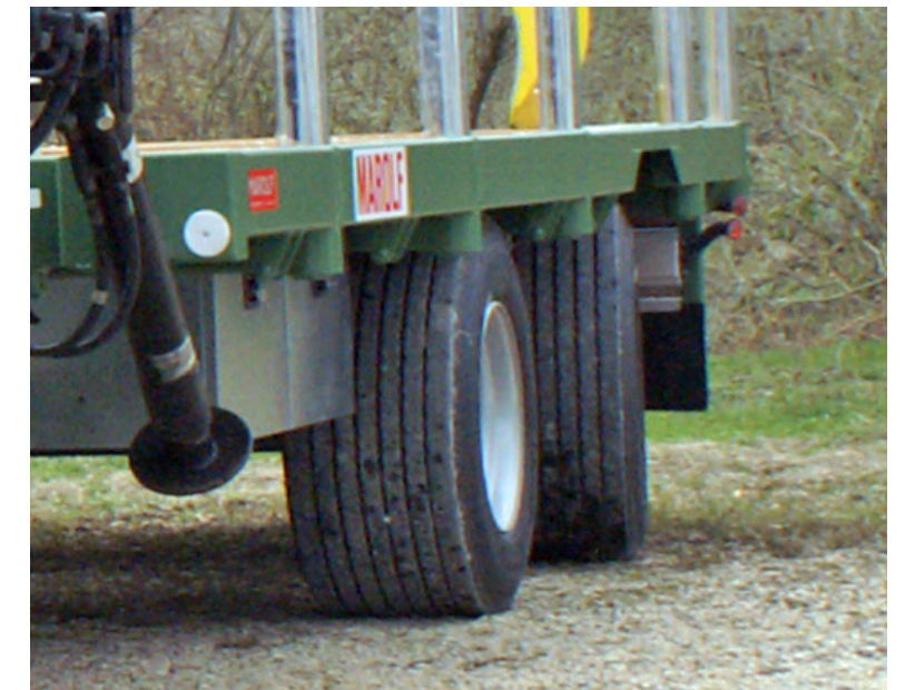
Zwangsgelenkte Nachlaufachse essieu suiveur directionel forcé
