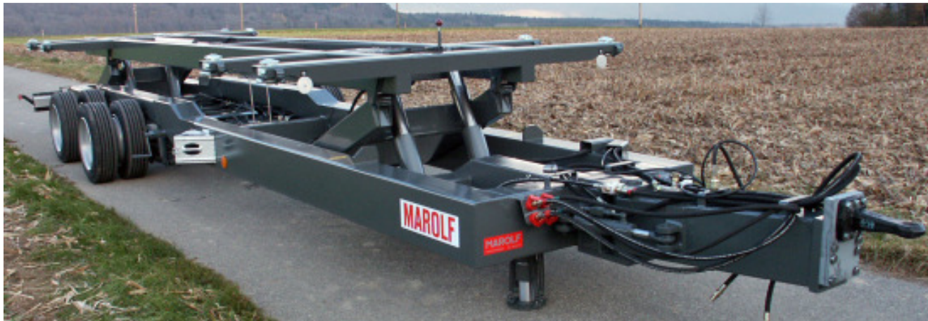
réglable en hauteur avec des vérins hydraulique
