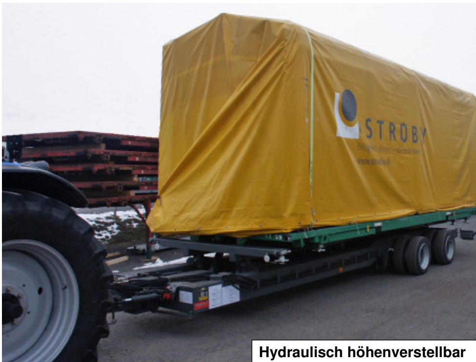
réglable en hauteur avec des vérins hydraulique
