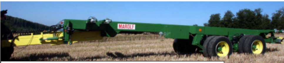
Höhenverstellbar mittels luftgefederter Achse und hydraulisch verstellbarer Deichsel
