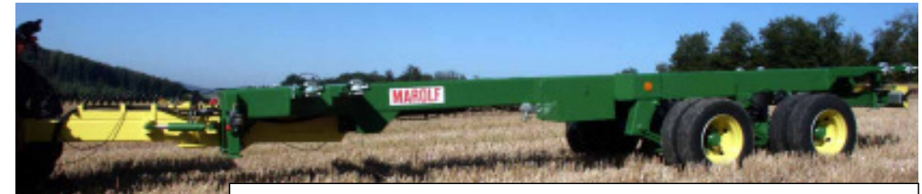
réglable en hauteur avec suspension à air et timon hydraulique
